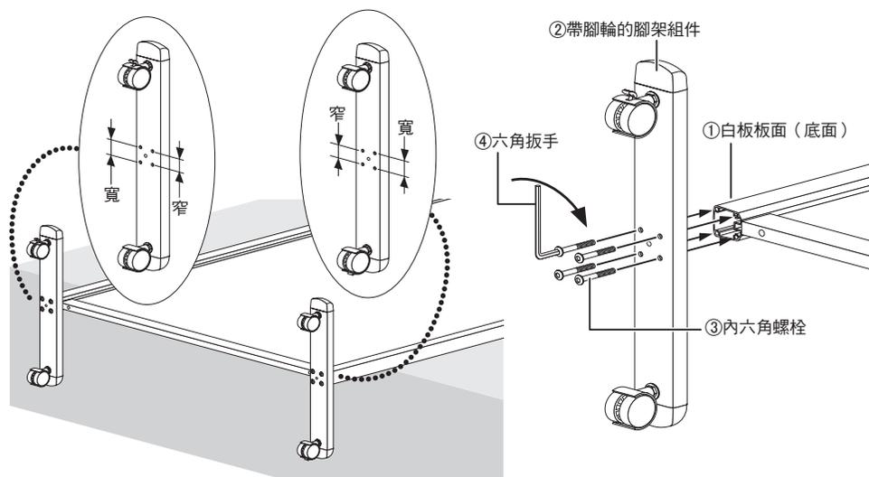
以上即完成安裝。請再次確認腳架的螺絲已確實鎖緊於白板板面。
